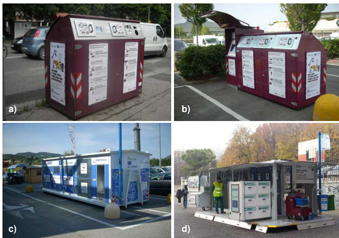
Abbildung 2-15: a) „RAEE-Point“-, b) „RAEE-Shop“- c) „RAEE-Parking“-Container d) „RAEE-Mobile“-Station [Newman et al. 2015]
