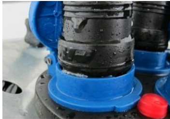
Prüfsituation beim IPX4-Test
