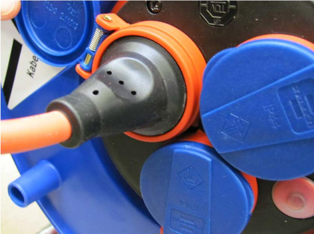
„IPX4 Bild 02 „Steckdose mit Dichtkragen“
