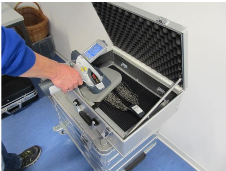
ABBILDUNG 23: RFA-MESSUNG EINER SCHMUCKWARE (QUELLE: RPT)
