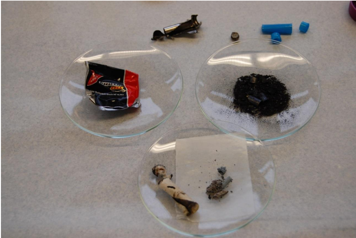
ABBILDUNG 21: IN EINZELTEILE ZERLEGTE BATTERIE VOR DEM AUFSCHLUSS (QUELLE: LUBW)
