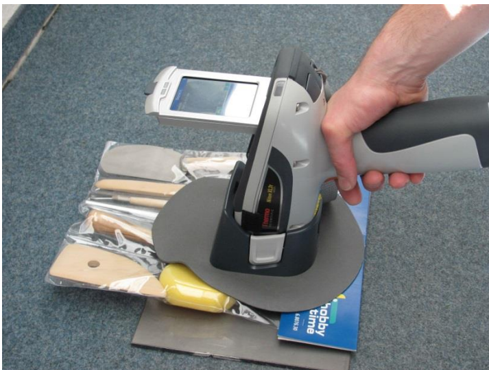
ABBILDUNG 1: MOBILES RÖNTGENFLUORESCENZANALYSEGERÄT (RFA) IM EINSATZ (QUELLE: RPT)
