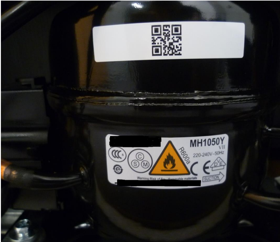
ABBILDUNG 39: KENNZEICHNUNG DES KÜHLAGGREGATS MIT ANGABE DES KÄLTEMITTELS (QUELLE: RPT)
