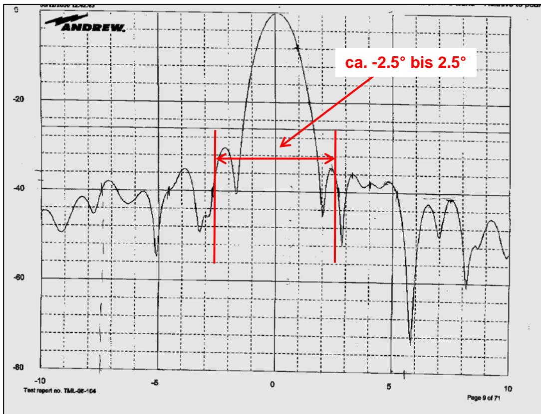
Abbildung 31: Antennendiagramm eines Wetterradars (Ausschnitt von -10° bis +10°)
