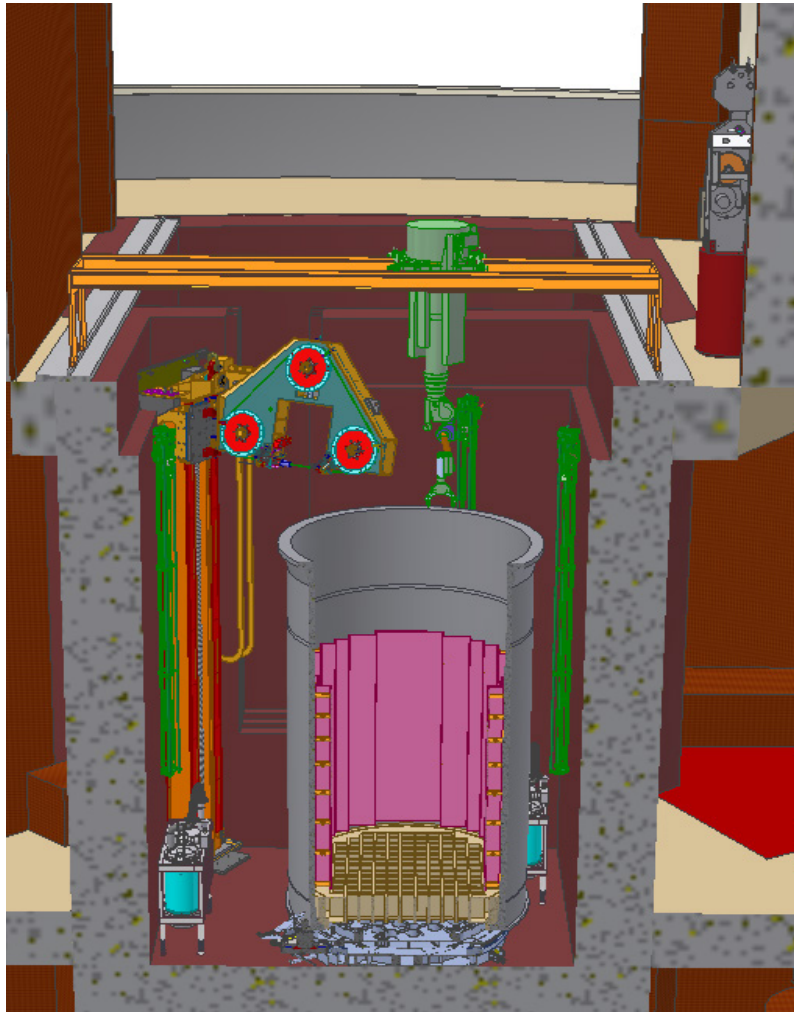
Abbildung 6-4 Beispielhafte Darstellung einer Zerlegung des Unteren Kerngerüstes im Nasszerlegebereich Reaktorbecken
