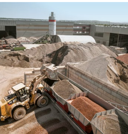
Beschickung eines Reihendoseurs mit den Komponenten der RC-GK Typ 2, Altbeton und Mauerwerk
