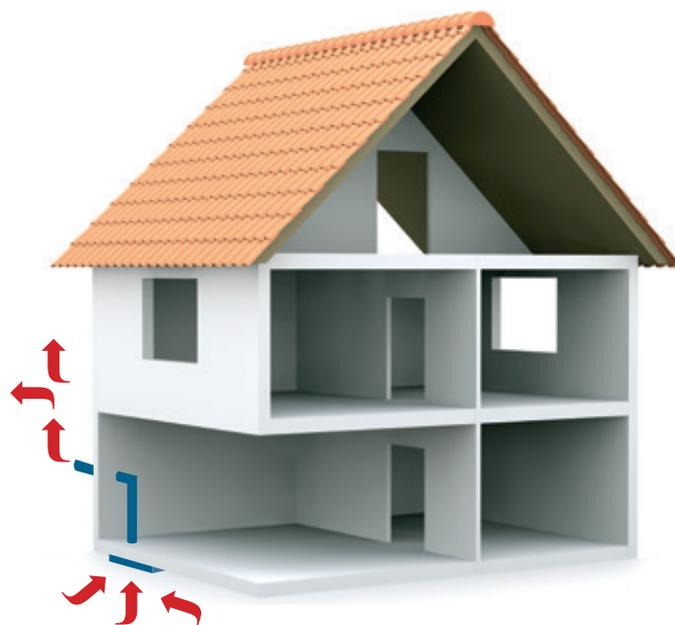
Schematische Darstellung eines Radonbrunnens
