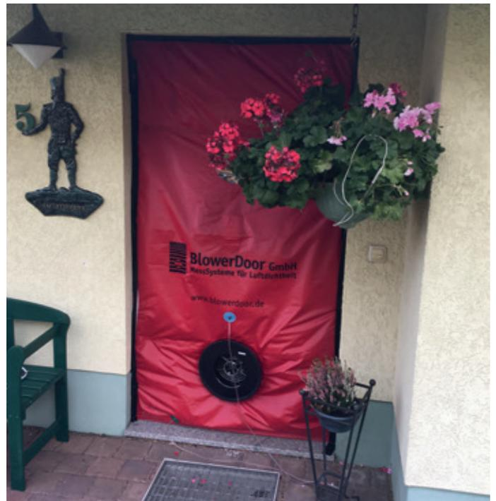
Blower-Door-Gerät zur Feststellung der Dichtheit eines Gebäudes
