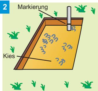
**2** Um ein Aufschwimmen des Bodens zu verhindern, wird er mit einer dünnen Kiesschicht abgedeckt. Ein Pfahl mit der Markierung wird so in den Boden geschlagen, dass sich die Markierung ca. 10cm über der Sohle befindet.
