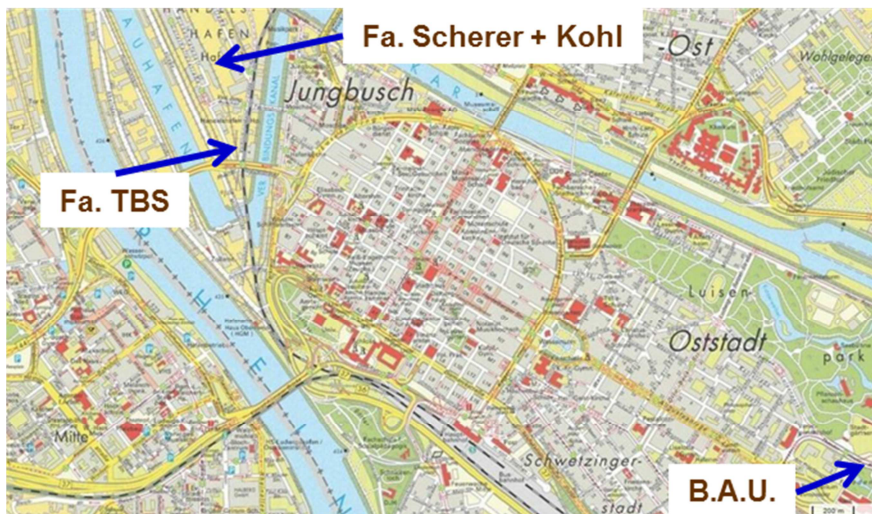
Abbildung 6.3: Ideale Lage der Gesteinskörnungsherstellung am Beispiel Mannheim; Gesteinskörnung: Fa. Scherer + Kohl; Betonwerk: Fa. TBS
