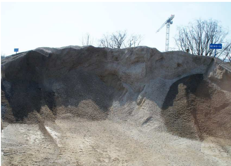
Abbildung 9.2: RC-Gesteinskörnung „M“ (Mischabbruchgranulat) in 0/16mm
